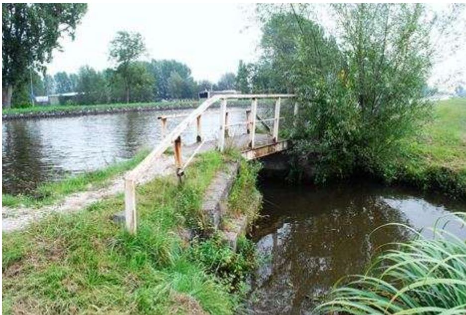
Figuur 4.9.6. Lijnbruggen hebben vaak aan één kant een verlaagde leuning om de teugels van het paard naar het schip er gemakkelijker overheen te geleiden. 197
