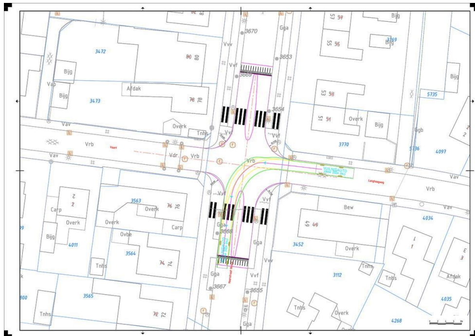
Afbeelding 15: principe ontwerp voetgangersoversteekplaats kruispunt Heerstraat-Noord - Langhaagweg
